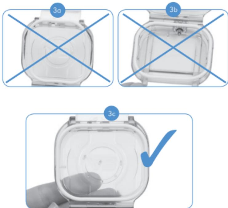
Pour insérer le nouveau joint torique, placer une partie du nouveau joint torique dans la rainure de montage de l'AquaCase. Veiller à faire correspondre la forme rectangulaire du joint torique avec celle de l'AquaCase.
