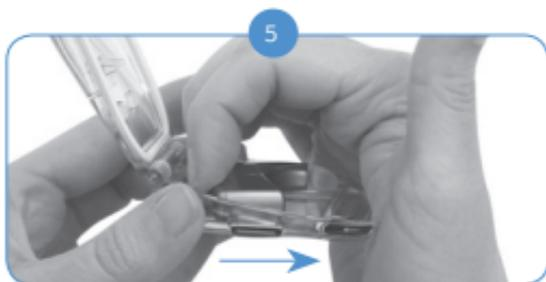
Om de Naída CI te kunnen verwijderen uit de AquaCase, schuift u voorzichtig de processor naar voren. Houdt er rekening mee om niet aan de Naída CI te trekken totdat deze niet langer is aangesloten.
