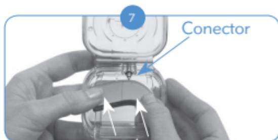
Alinee el cable de la antena receptora del procesador (situado en el lomo posterior del Naída CI por debajo del botón de programa) con el conector del cable ubicado en el interior del AquaCase. Deslice el Naída CI hacia el interior del AquaCase hasta que se realice la conexión.
