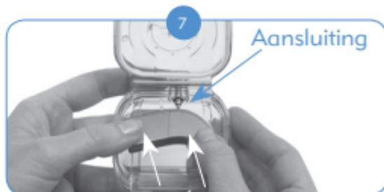
Plaats de processors zo dat de aansluiting van de zendspoelkabel (bevindt zich op de rug van de Naída CI onder de Programmaknop) uitgelijnd is met de kabelaansluiting van de AquaCase. Schuif de Naída CI in de AquaCase tot de verbinding gemaakt is.
