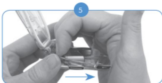
Pour retirer le Naída CI, faire soigneusement glisser le processeur vers l'avant, en veillant à ne pas tirer avant que le Naída CI soit dégagé du connecteur.
