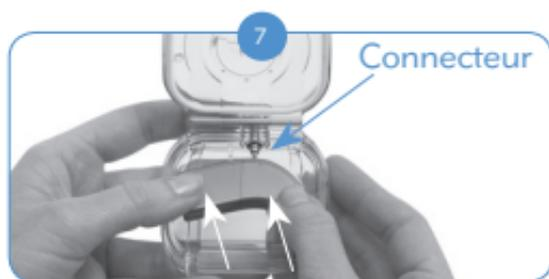
Aligner le connecteur du cordon de l'antenne du processeur de son (situé au dos du Naída CI sous le bouton de programmation) avec le connecteur du cordon situé à l'intérieur de l'AquaCase. Faire glisser le Naída CI dans l'AquaCase jusqu'à ce que le branchement soit correct.
