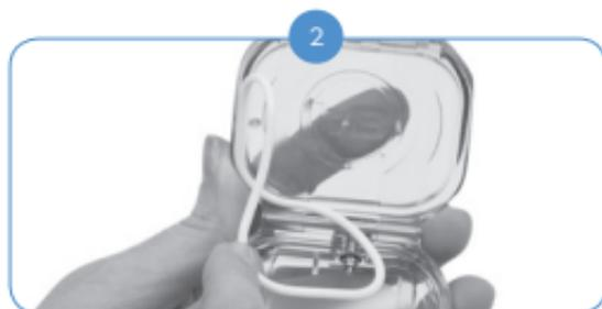
Sobald der Ring an einer Stelle herausragt, können Sie ihn greifen und vollständig aus der Nut herausziehen.
