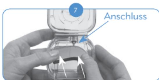
Setzen Sie das Naída CI so in das AquaCase ein, dass der Überträgerkabelanschluss auf der Rückseite des Prozessors (unterhalb der Programmtaste) direkt am Kabelanschluss liegt, der sich innerhalb des AquaCase befindet. Drücken Sie das Naída CI vollständig in das AquaCase, bis die Verbindung hergestellt ist.
