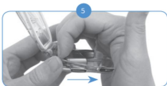
Para extraer el Naída CI, deslice con cuidado el procesador hacia delante y asegúrese de no tirar hacia arriba hasta que el Naída CI esté desconectado del conector.
