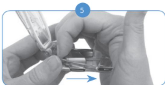
Para remover o Naída CI, deslize cuidadosamente o processador para frente, certificando-se de puxar para cima até que o Naída CI esteja desengatado do conector.
