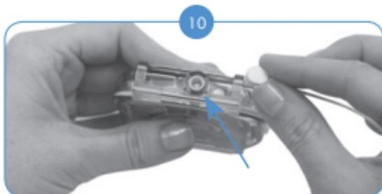
Sluit de AquaMic-zendspoel aan op de AquaMic-kabel. Druk de kabelaansluiting van de AquaMic stevig in de aansluiting van de AquaCase.
