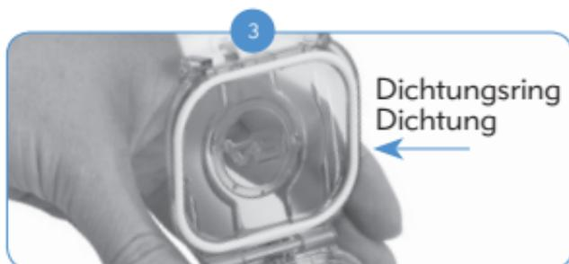
Überprüfen Sie den korrekten Sitz des Dichtungsring, bevor Sie das Naída CI in das AquaCase einsetzen. Stellen Sie sicher, dass der Dichtungsring nicht ausgetrocknet, brüchig oder schmutzig ist. Sollte eine dieser Eigenschaften zutreffen, tauschen Sie den Dichtungsring aus.
