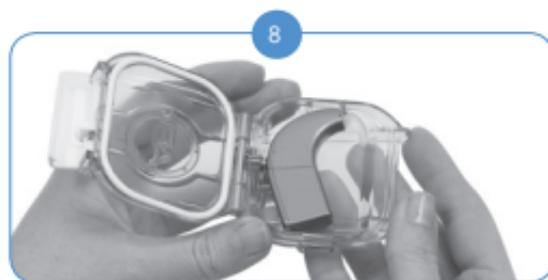
O Naída CI deve se encaixar firmemente na parede traseira do AquaCase e permanecer em contato com a superfície inferior.
