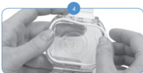
Mientras sostiene la junta tórica en la ranura con una mano, con la otra estire con precaución el resto de la junta tórica para que encaje en lo que queda de la ranura.
