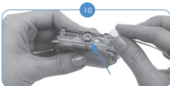
Conecte la antena receptora del AquaMic con el cable del AquaMic. Para obtener más información, consulte las "Instrucciones de uso" del AquaMic. Introduzca el conector del cable del AquaMic firmemente en el conector del AquaCase.
