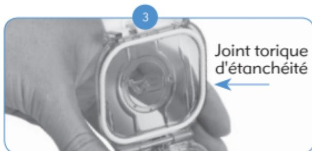
Avant de placer le Naída CI dans l'AquaCase, inspecter le joint torique pour s'assurer de son étanchéité. **Vérifier que le joint torique n'est pas sec, cassant ou sale. Si c'est le cas, remplacer le joint torique avant utilisation.**
