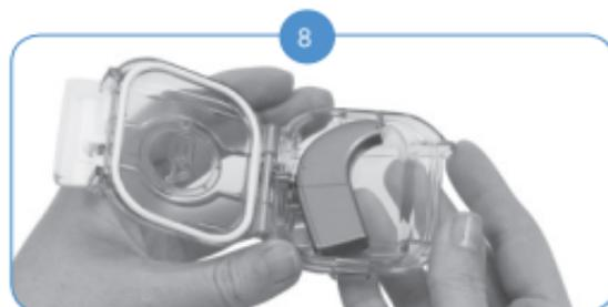
Die Naída CI sollte dicht an der Rückwand des AquaCase sitzen und flach an der Bodenoberfläche anliegen.
