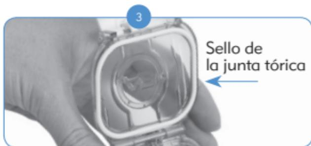
Antes de colocar el Naída CI en el AquaCase, compruebe visualmente que la junta tórica esté correctamente fijada. **Compruebe visualmente que la junta tórica no está seca, rota ni sucia. De ser así, sustitúyala antes de utilizarla.**
