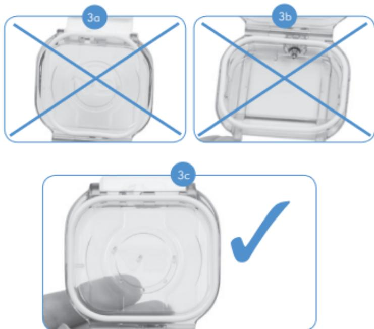
Plaats een klein stukje van de nieuwe o-ring in de bevestigingsgroef van de AquaCase-houder om de nieuwe o-ring te plaatsen. Zorg er hierbij voor dat de rechthoekige vorm van de o-ring op alle punten overeenkomt met de rechthoekige vorm van de AquaCase.
