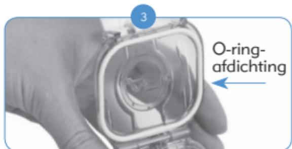
Voordat u de Naída CI in de AquaCase plaatst, dient u te controleren of de o-ring-afdichting overal goed op de plek zit. **Controleer of de o-ring niet droog, broos of vuil is. Is dit het geval, dan dient u de o-ring te vervangen voordat u de AquaCase gaat gebruiken.**
